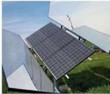
光伏发电系统聚光器
